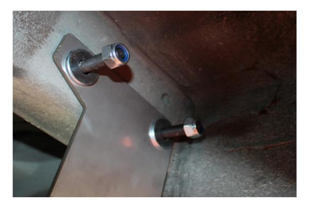
Place the step on the brackets and tighten the nuts bij hand
